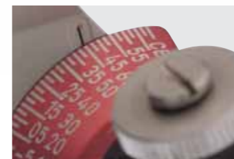
Des graduations "grand format" garanties d'un réglage optimal de l'articulateur.
